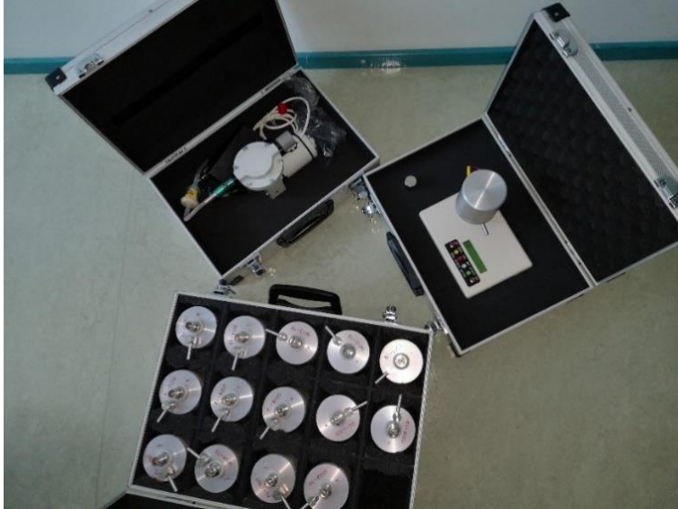
Foto 4.2.2. Radoonimõõduri RM-2 osad: a) pump vaakumi tekitamiseks, b) elektromeeter radoonisisalduse edastamiseks, c) kolvid (Foto: K. Täht-Kok)
