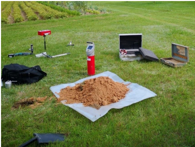
Foto 4.2.3. Rn-mõõtmisel kasutatakse mitmeid töövahendeid, alates lihtsast labidast kuni keeruliste mõõtmisseadmeteni. Punane silindrikujuline gammaspektromeeter on foto keskel (Foto: K. Täht-Kok)
